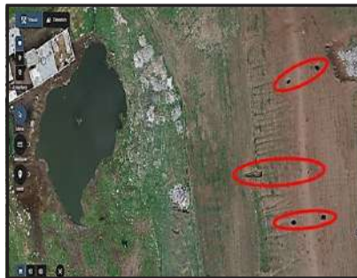
الشكل (8): الانفاق المحفورة حديثاً، نظرة مقربة من صور الطائرة المسيرة بدقة تمييز 5 سم والتي من الصعب تمييزها في صور الاقمار الصناعية او حتى من النظر الافقي الارضي.
